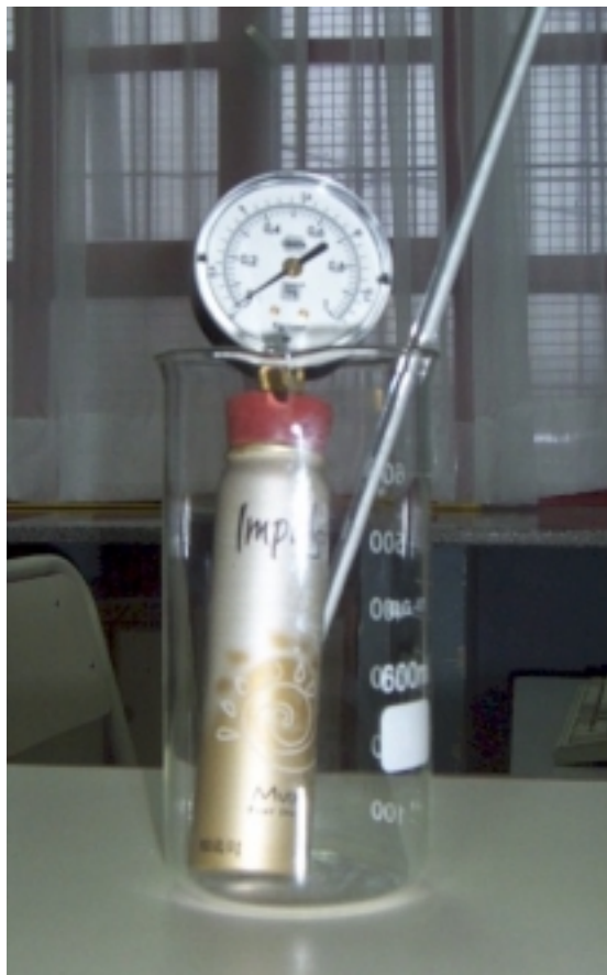
Figura 1 Dispositivo experimental para estudiar un proceso a volumen constante.
