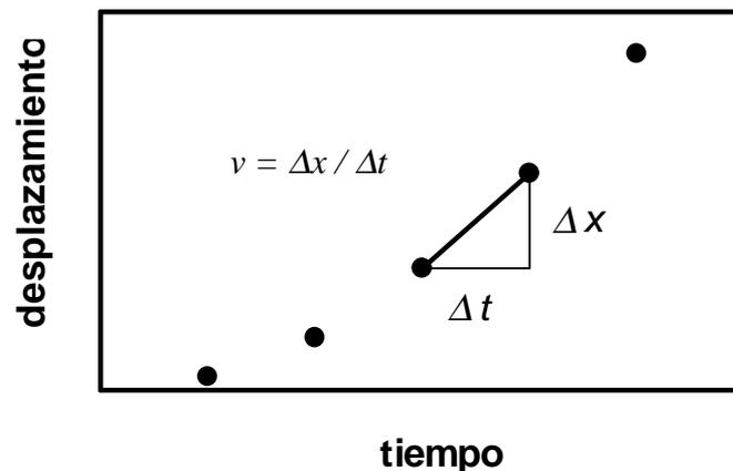
**Figura 2** Determinación de la velocidad en un intervalo de tiempo a partir de los datos de desplazamiento en función del tiempo. La velocidad media calculada debe asociarse al tiempo medio del intervalo en consideración.
