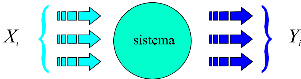
Figura 1 Representación de un sistema al que se estudia las respuestas Y_i cuando se varía el conjunto de variables X_i .
